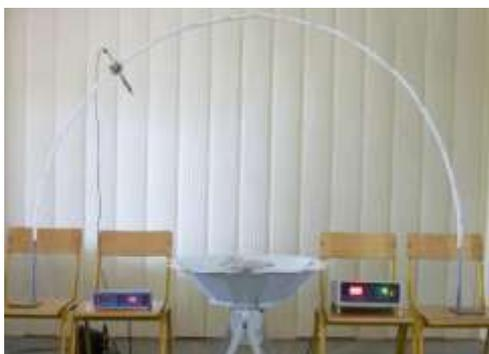
Рисунок 11 – Стенд для измерения звукового давления
