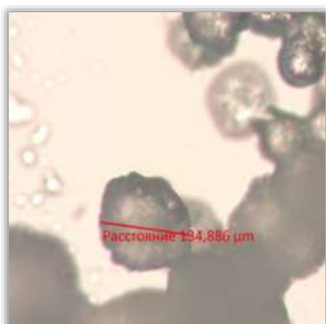
Рисунок 1 – Микрокапсулы с ПНЖК рыжикового масла (световой микроскоп)
