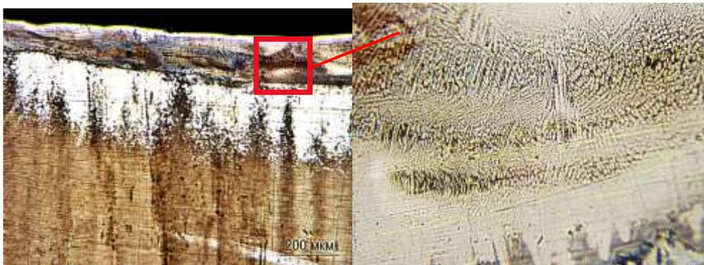
Рисунок 4 – Микроструктура стали 5ХНМ после боромеднения с последующей электронно-пучковой обработкой
