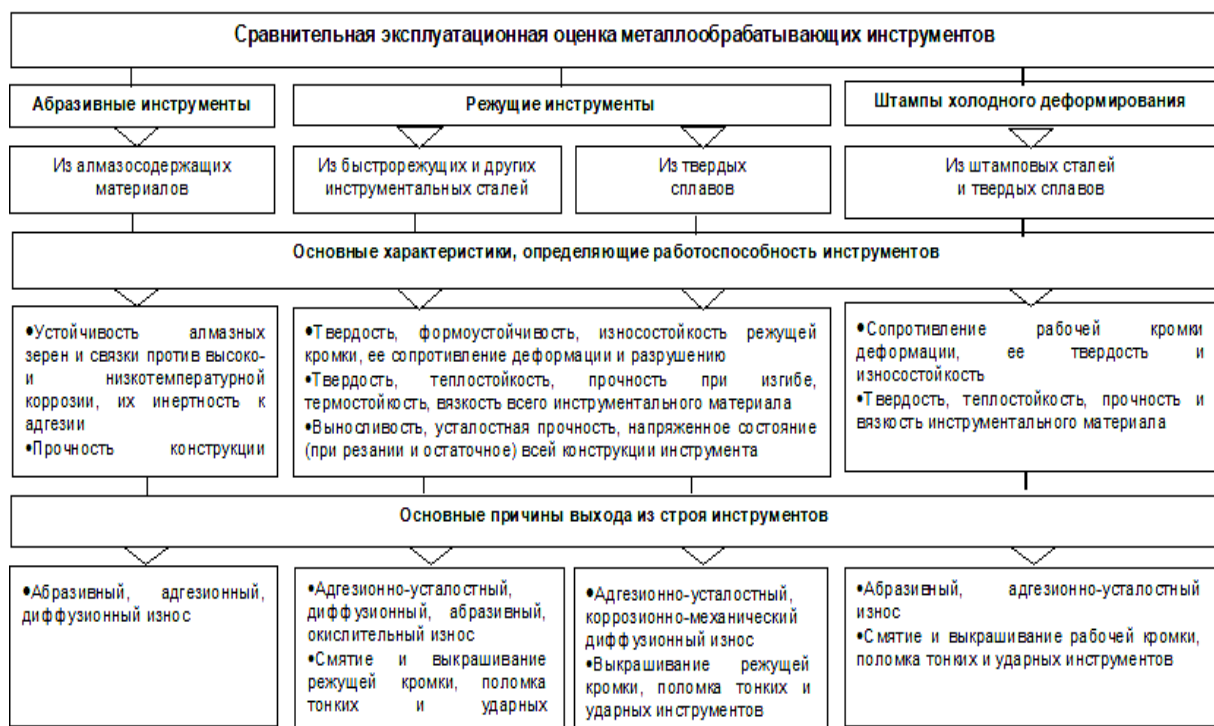
Рисунок 1 – Эксплуатационные требования и причины выхода из строя металлообрабатывающих инструментов [15]
