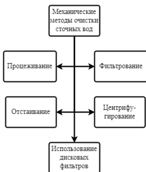
Рисунок 2 – Методы механической очистки сточных вод Figure 2 – Methods of mechanical wastewater treatment
