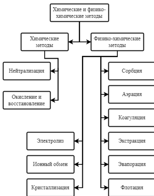
Рисунок 3 – Химические и физико-химические методы очистки сточных вод Figure 3 – Chemical and physico-chemical methods of wastewater treatment
