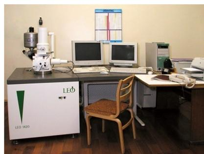
Рисунок 1 – Сканирующий электронный микроскоп LEO 1420
