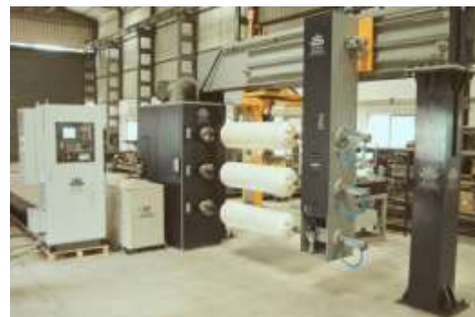
Рисунок 4 – Технологический процесс спиральной намотки баллонов давления
