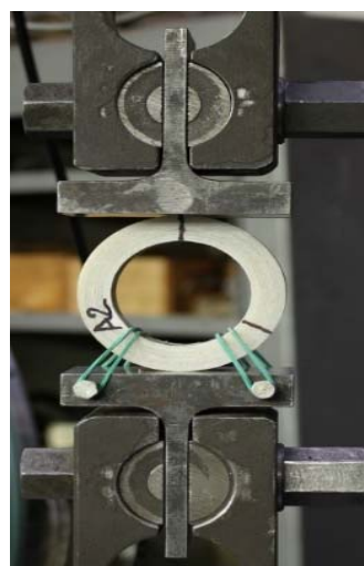
Рисунок 1 – Вид кольцевого образца, установленного в захватах испытательной машины BiSS UTM-100 kN
