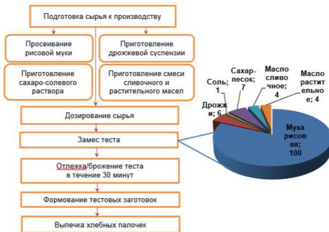
Рисунок 2 – Технологическая схема приготовления хлебных палочек из рисовой муки
