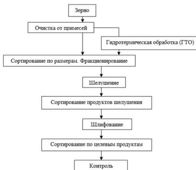
Рисунок 1 – Технологическая схема подготовки крупы из овса
