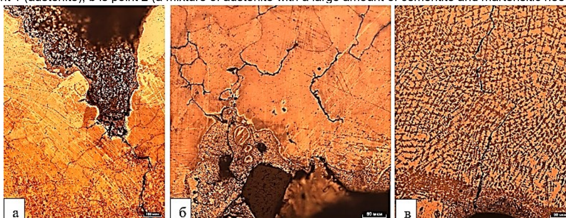
Рисунок 3 – Микроструктура различных участков образцов стали 110Г13Х2БРЛ, представленных на рисунке 1б, где а – п. 3 (дефект со шлаковым включением и трещиной), б – п. 4 (дефект поверхности со шлаковым включением и прослойками карбидов по границам зёрен), в – п. 5
