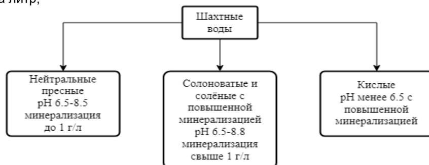
Рисунок 2 – Классификация шахтных вод
