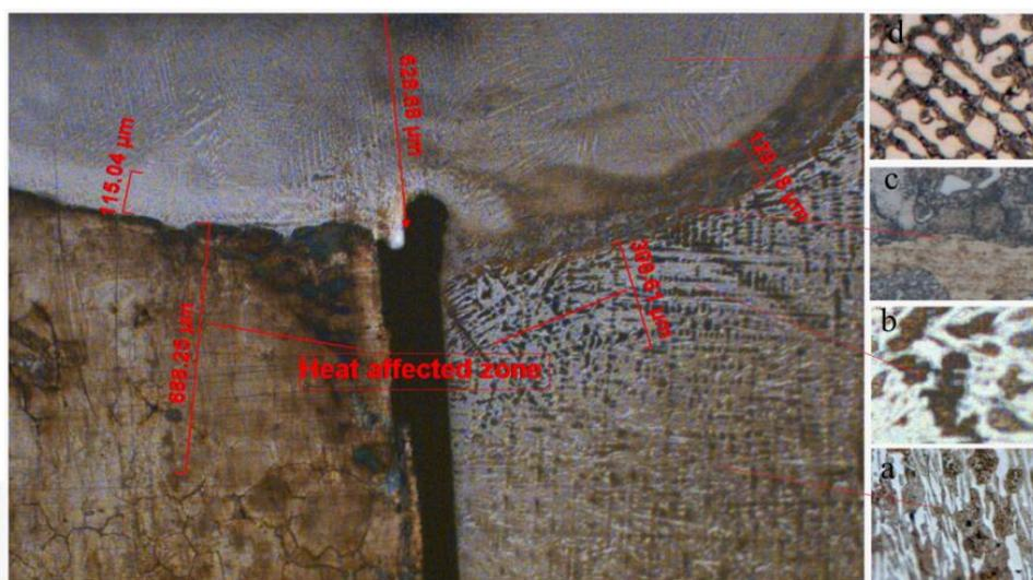
Рисунок 5 – Изменения микроструктуры при лазерной сварке чугуна со сталью:
