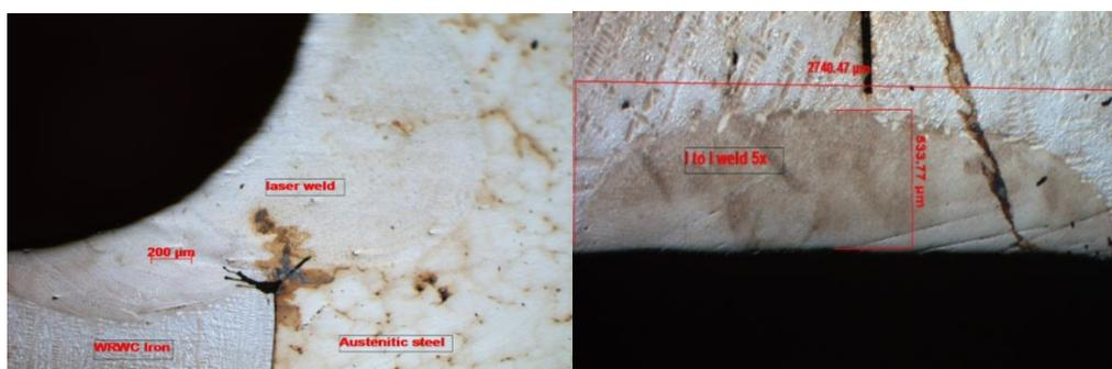
Рисунок 4 – Сварка (а) Т-образного соединения чугуна со сталью и (б) фланцевого соединения чугуна с чугуном
