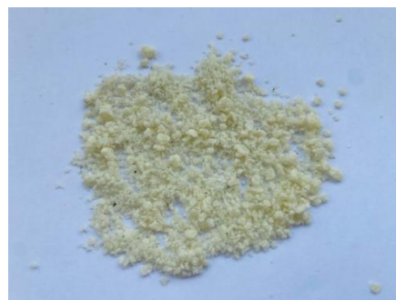
Рисунок 3 – Целлюлозный продукт из шелухи рапса, подвергнутой предварительной экстракции горячей водой и этанолом
