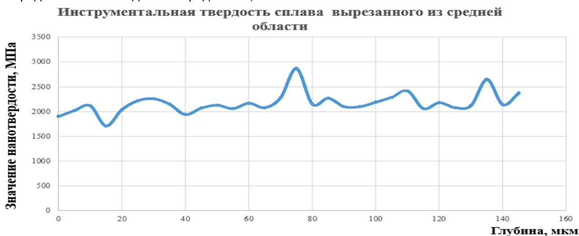
Рисунок 4 – Электронно-микроскопическое изображение поверхности алюминиевого сплава 7075 и нанотвердость в зависимости от глубины заготовки
