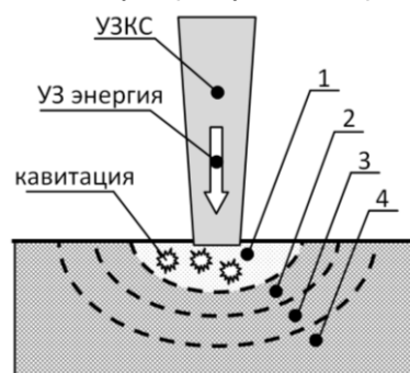
Рисунок 1 – Схема введения УЗ колебаний в полимерный материал
