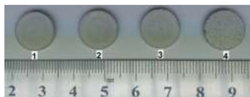
Рисунок 1 – Внешний вид образцов композита с различным размером частиц наполнителя:
