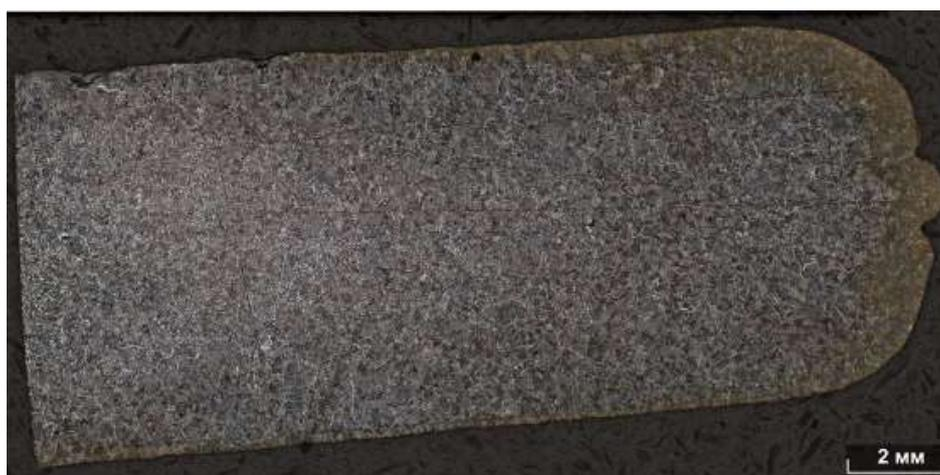
Рисунок 2 – Макро- и микроструктура образцов после отжига
