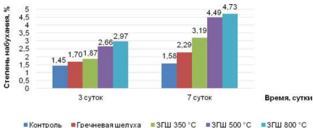
Рисунок 3 – Изменение массы эпоксидных композиций, наполненных ГШ и ее золой, полученной при различных температурах, в результате экспозиции в 5 % растворе серной кислоты
