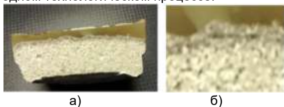
Рисунок 5 – Поперечное сечение образца, полученного совмещением дисперснонаполненного минерального композита и эпоксидного полимера (а), граница раздела минеральной и полимерной фаз (б)
