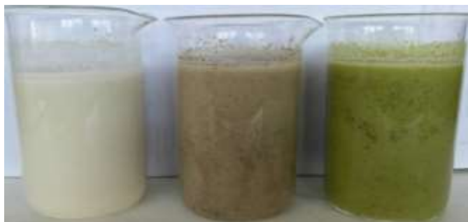
Рисунок 1 – Образцы суспендированных основ из кунжутной, амарантовой и тыквенной муки после обработки в ультразвуковом поле.
