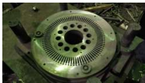
Рисунок 1 – Фото формообразующей детали вырубного штампа из стали Х12МФ
