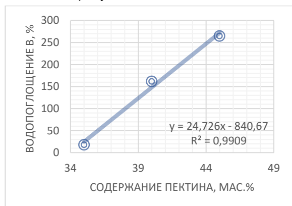
Рисунок 1 – График зависимости водопоглощения β составов 4–6 от содержания пектина
