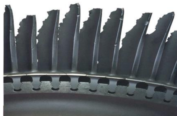
Рисунок 4 – Термоусталостное разрушение лопаток турбин
