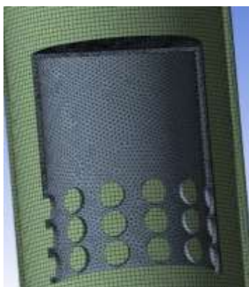
Рисунок 2 – Трехмерный вид внутренней трубы с отверстиями
