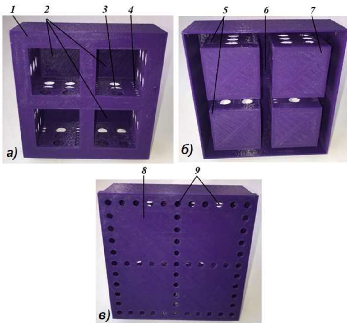
Рисунок 1 – Мультивихревой сепаратор с элементами квадратной формы (а – вид спереди; б, в – вид сзади): 1 – корпус; 2 – входные отверстия в устройство; 3 – большие круглые отверстия; 4 – малые круглые отверстия; 5 – элементы квадратной формы; 6 – сепарационные каналы; 7 – крышки элементов квадратной формы; 8 – крышка с круглыми отверстиями; 9 – круглые отверстия в крышке; б – первый вариант компоновки устройства; в – второй вариант компоновки устройства
