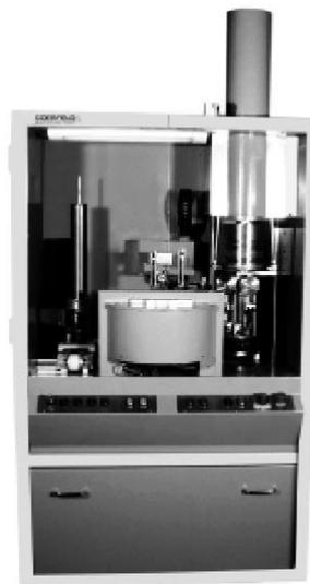
Рисунок 1 – Измерительная установка для вязкоупругих жидкостей Cossfield RT-1394H
