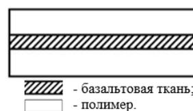
Рисунок 1 – Изображение композиционного материала:
