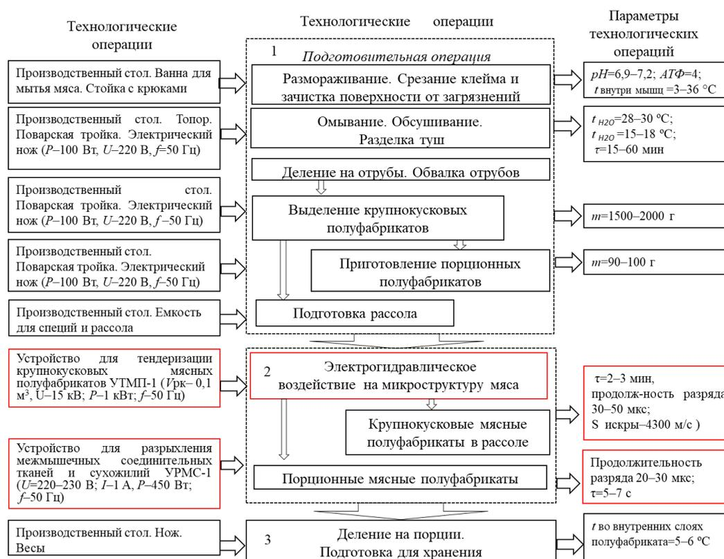
Рисунок 1 – Технологические операции электрогидравлического размягчения мышечных соединительных тканей и сухожилий в толще мясных полуфабрикатов
