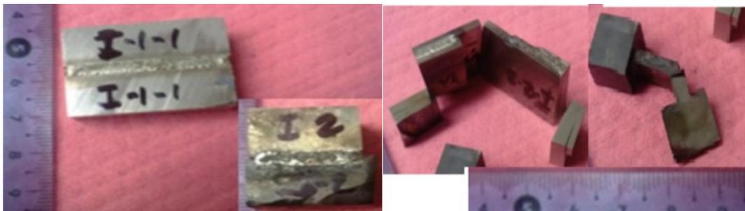
Рисунок 3 – Лазерная сварка образцов чугуна–чугун и чугуна–сталь
