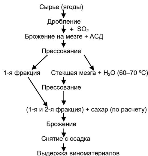
Рисунок 2 – Технологическая схема производства ягодных виноматериалов
