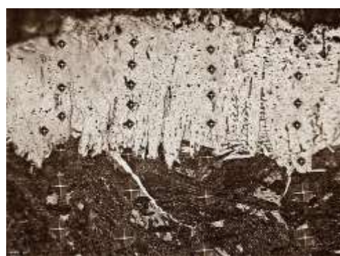
Рисунок 3 – Микроструктура диффузионного слоя стали 5ХНМ после комплексного поверхностного насыщения бором и медью
