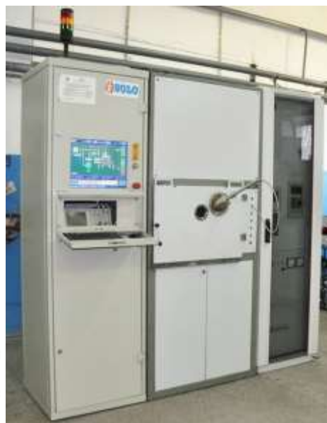
Рисунок 1 – Схема обработки в импульсной электронно-лучевой установке и внешний вид установки СОЛО (ИСЭ СО РАН): 1 – плазменный катод; 2 – электронный пучок; 3 – линза; 4 – кварцевое стекло; 5 – оптоволоконный кабель; 6 – образец; 7 – термопара; 8 – стол-манипулятор; 9 – мультиметр; 10 – высокоскоростной инфракрасный пирометр; 11 – осциллограф
