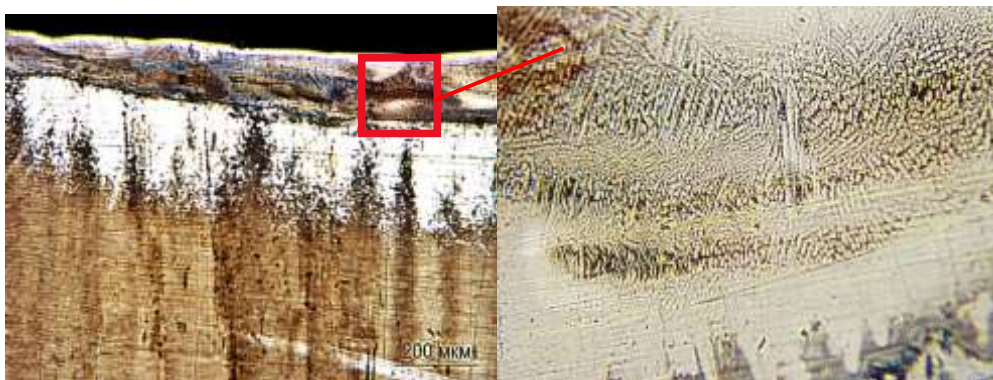
Рисунок 4 – Микроструктура стали 5ХНМ после боромеднения с последующей электронно-пучковой обработкой
