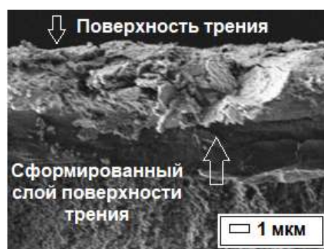
Рисунок 7 – Поперечный срез поверхности трения композита, содержащего 2 мас. % серпентина
