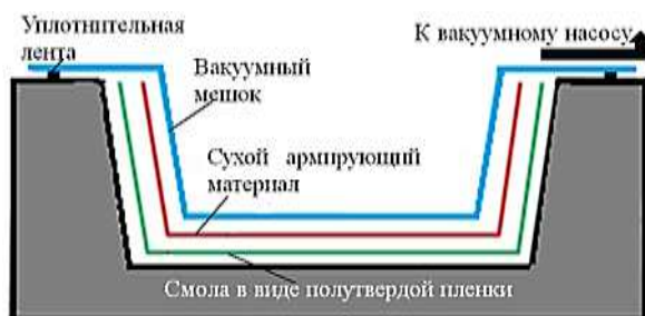
Рисунок 1 – Технологический пакет для изготовления изделий из ПКМ методом RFI
