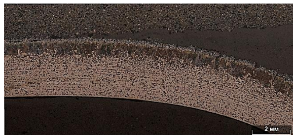
Рисунок 2 – Оптическое изображение области разрушения металлокомпозита после испытаний на адгезию металлокерамической составляющей металлокомпозитного брикета методом трехточечного изгиба
