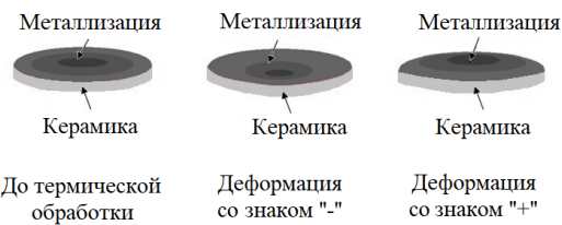
Рисунок 4 – Схематическое изображение процесса деформации металлизированного диска после высокотемпературной обработки
