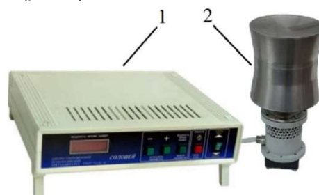
Рисунок 4 – Ультразвуковой аппарат с поршневым излучателем: 1 – электронный генератор, 2 – колебательная система
