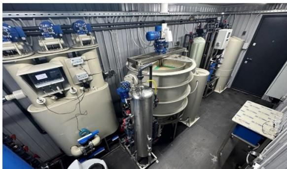
Рисунок 4 – Пилотная установка ФХО
