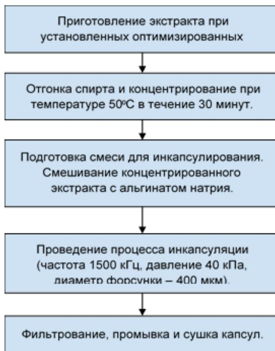
Рисунок 1 – Схема проведения инкапсулирования
