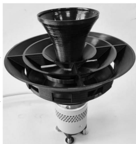
Рисунок 2 – Чертеж (а) и фото (б) ультразвукового излучателя с отражателем и рупором Figure 2 – Drawing and photo of an ultrasonic emitter with a reflector and horn
