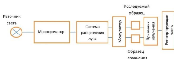
Рисунок 3 – Схема строения спектрофотометра
