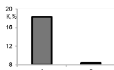
Рисунок 4 – Зависимость коэффициента вариации величины r_v в серии изделий от давления при вулканизации: 1) прессовая (P=125 атм); 2) беспрессовая (P=6 атм)
