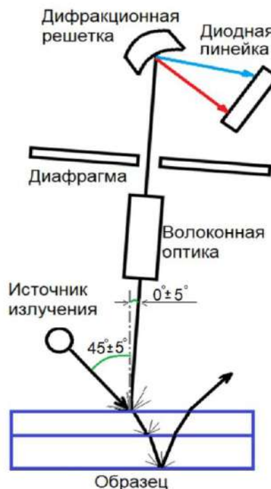
Рисунок 3 – Схема измерения спектра отражения света от поверхности образца (зеркала) в спектрофотометре X-Rite i1Pro
