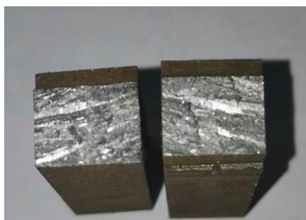
Рисунок 2 – Фото излома образца системы Al-Co-Cr-Fe-Mn после проведения испытания на ударную вязкость
