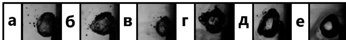
Рисунок 2 – Поверхностные возмущения барботажного пузырька при различной концентрации глицерина: а) глицерин – 0 %; б) глицерин – 10 %; в) глицерин – 37,5 %; г) глицерин – 50 %; д) глицерин – 60 %; е) глицерин – 80 %
