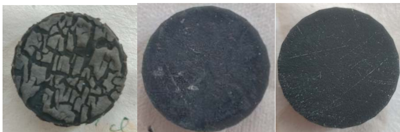
Рисунок 5 – Образцы после травления: а) полученный по методике [3]; б) при температуре 65 °C, время 15 минут; в) по оптимизированной методике
