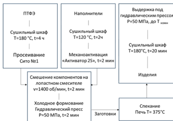
Рисунок 2 – Технологическая схема получения ПКМ на основе ПТФЭ
