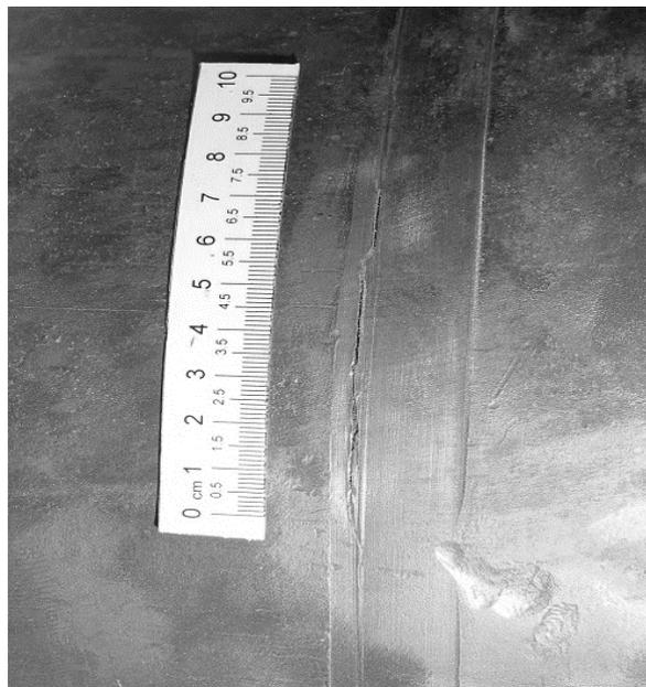
Рисунок 1 – Трещина на обследуемом сварном шве
