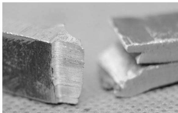
Рисунок 5 – Характер разрушения дефектных образцов
