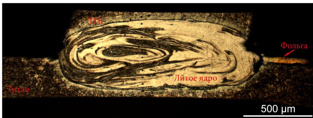
Рис.3. Макроструктура литого ядра (режим 3)
