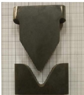
**Рис.4.** Оснастка для проведения технологической пробы на изгиб
