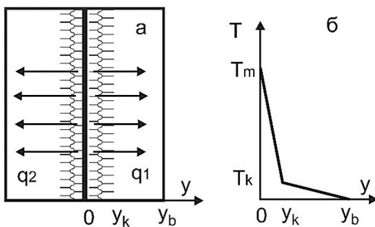
**Рис.3.** Схема соединения двух контактных тел (а) и традиционно принятая зависимость изменения температуры (б); заштрихованы области переходного сопротивления,  $q$  – плотность потоков тепла,  $T$  – отклонение температуры от среднего значения
