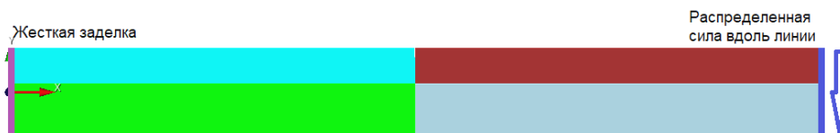
Рис.5. Условия закрепления и нагружения образца с надрезом и трещиной. Левый конец образца жестко закреплен, на правый действует изгибающая сила, распределенная по торцу образца
