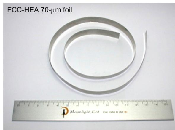
**Рис.1.** Рулонная фольга толщиной семьдесят микрометров из сплава  $Al_5Cr_{12}Fe_{35}Mn_{28}Ni_{20}$ , полученная дуговой плавкой и холодной прокаткой. Удлинение при прокатке составляет 4257 % в зависимости от заготовки с начальной толщиной около 3 мм и твердостью 147 HV [13, 23]
