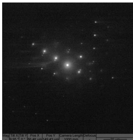
Рис. 6. Изображение микродифракционной картины, полученной с участка покрытия системы \text{TiB}_2\text{-Ni-Ag} и схема ее расшифровки
