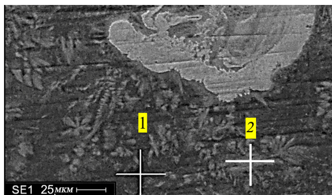
Рис.5. Электронно-микроскопическое изображение структуры пластинчатой кристаллизации слоя подложки, примыкающего к переходному слою; значком «+» обозначены участки, элементный состав которых приведен в Табл.4
