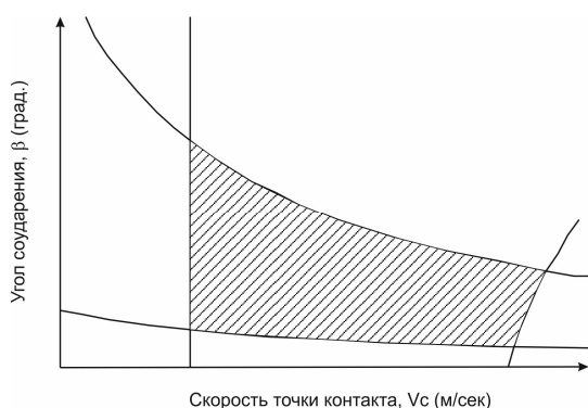
Рис.2. «Окно свариваемости» в координатах угол соударения – скорость точки контакта
