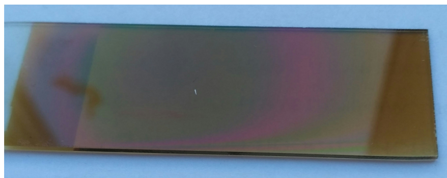
Рис.3. Алмазоподобная аморфная углеродная пленка, нанесенная на подложку из силикатного стекла, полученная лазерным испарением углеродной мишени. Размеры площади, покрытой пленкой 75 \times 26 \text{ мм}^2
