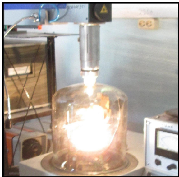
Рис.1. Экспериментальная установка для получения тонких углеродных пленок, состоящая из вакуумной установки и мощного твердотельного лазера NTS 300
