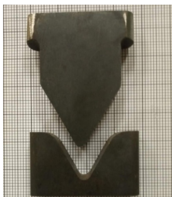
Рис.4. Оснастка для проведения технологической пробы на изгиб
