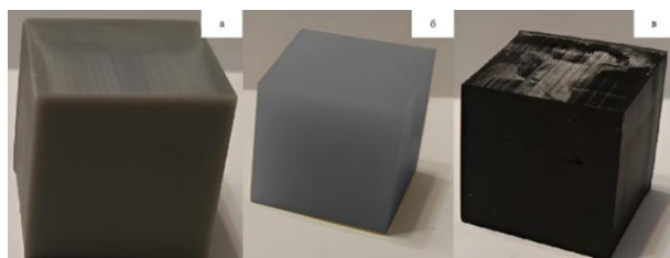
Рис. 7. Изготовленные опытные модифицированные образцы графитовым наполнителем после воздействия щелочной среды с pH 13, где а – образец №4; б – образец №5; в — образец №6
