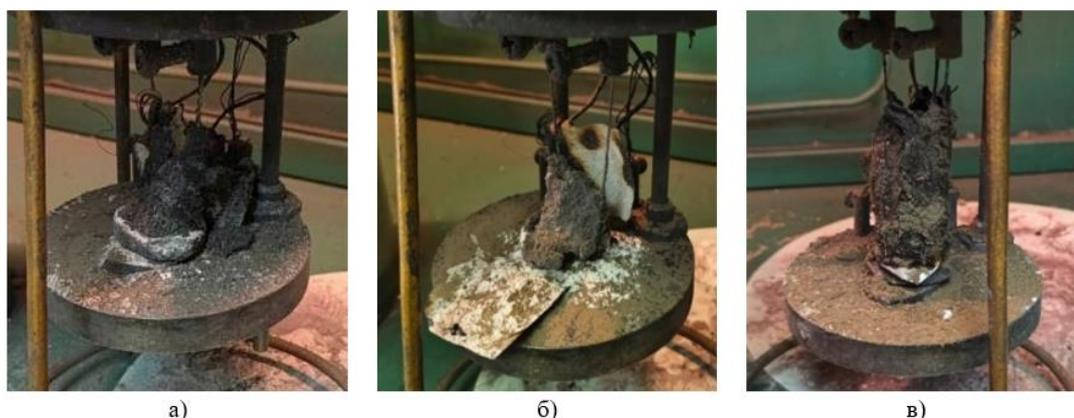
**Рис. 2.** Конечные продукты, образовавшиеся после сгорания исходной шихты  $\text{SiO}_2\text{-NaN}_3\text{-AlF}_3$ , с учетом использования частиц  $\text{SiO}_2$  разного размера: а) 0,8-1,2 мм; б) 0,1-0,3 мм; в) 10-40 нм
